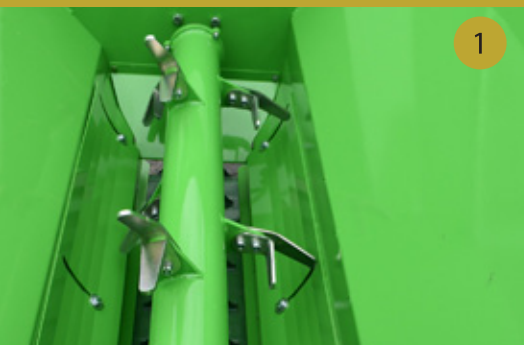
vyskladňovací pás s čechračem / unloading belt and cylinder with shovels
