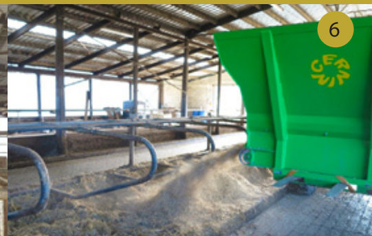
regulace rychlosti a vzdálenosti zakládání materiálu / regulation of speed and location of falling material
